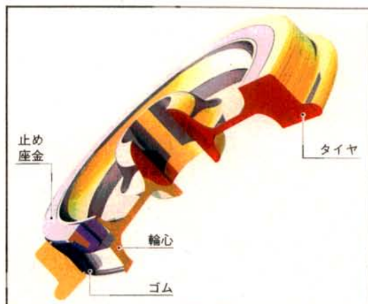
【図2】 事故車両となったICEに採用されていた圧縮型弾性車輪の構造。輪心、ゴム、タイヤ、止め座金から成る。輪心と止め座金の外周にタイヤをかぶせ、これら三つの部品の内部に生じるV字形のすき間にゴムを配した。止め座金は側面からボルトで締結する。欠陥は、輪心、タイヤ、ゴムの剛性に大きな違いがあったこと。その結果、繰り返し応力がかかってタイヤの内周部に亀裂が発生、進展して破断した
