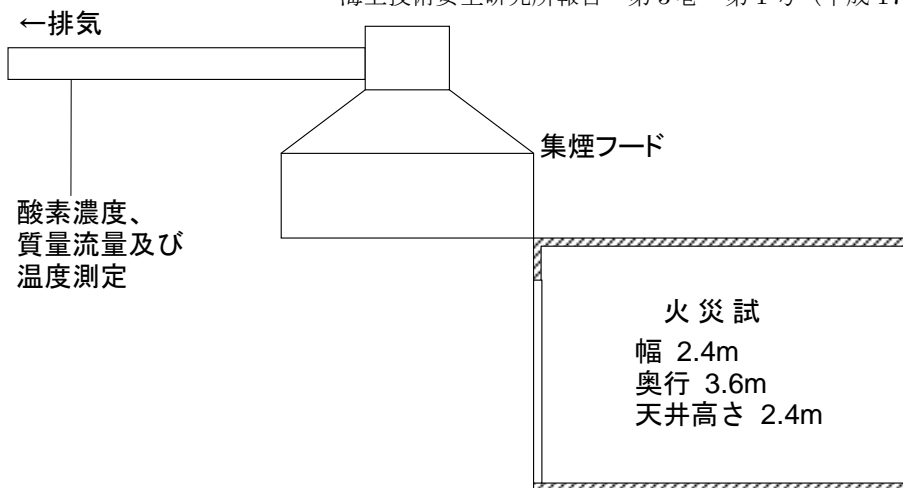
図-4.2 ISO9705 室内火災試験設備
